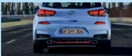
Sportabgasanlage mit zwei Endrohren und variabler Klappensteuerung<sup>1</sup>
